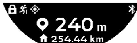
在回到起點的路上，腕錶使用GPS訊號來引導您。這些資料會不間斷地計算，且取決於接收到的GPS訊號。根據您所處的環境，訊號可能會暫時消失。在這種情況下，腕錶螢幕會顯示閃爍的衛星圖示，表示「GPS」接收到的訊號不足以提供足夠的精確度引導您。
