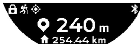
En el camino de vuelta al punto de partida, el reloj utiliza la señal GPS para guiarle. Estos datos se calculan de forma continua y dependen de la señal GPS recibida. Según el entorno en el que se encuentre, puede perderse la señal durante un momento. En este caso, la pantalla del reloj muestra el icono parpadeante de un satélite para indicar que la recepción «GPS» es insuficiente para guiarle con precisión.
